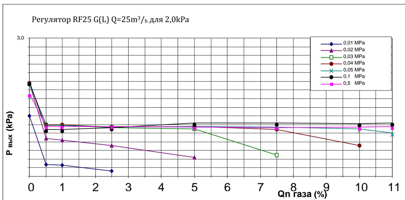
Пропускная способность регулятора RF25 G(L) Arctic
