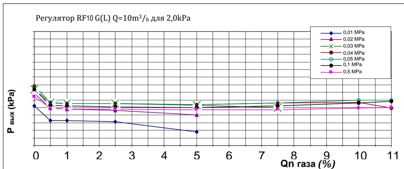
Пропускная способность регулятора RF10 G(L) Arctic
